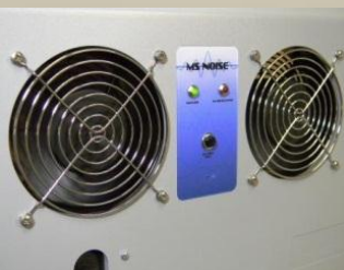
温度センサー&長寿命冷却ファン (480m 3 /hour)
