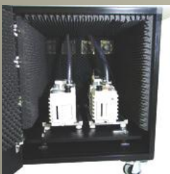
防音ポンプ格納庫
