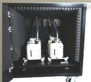
防音ポンプ格納庫
