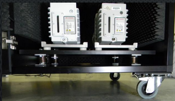
振動を99%カットする免震構造と強力ストッパー付ホイール
