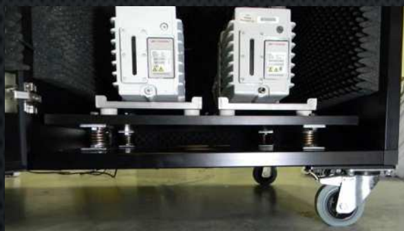
振動を99%カットする免震構造と強カストッパー付ホイール
